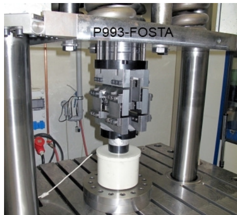
Abbildung 11. Übersichtsaufnahme eingebaute 4-Punkt-Biegevorrichtung
