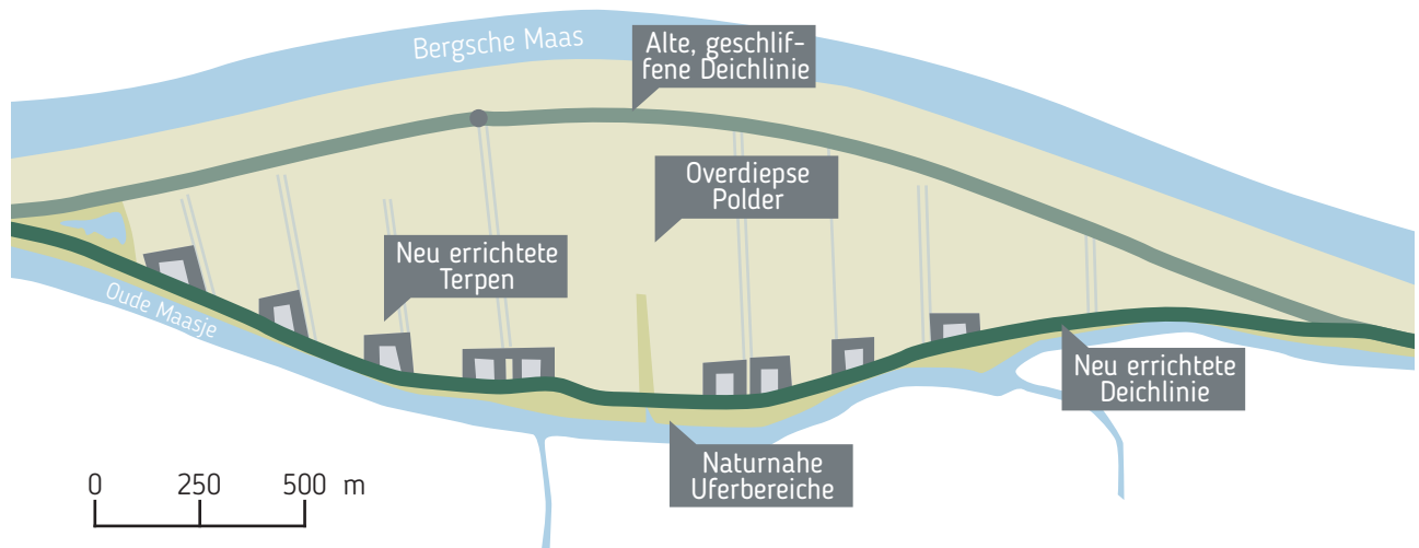
Abb. 42 Übersicht des Teilprojekts Overdiepse Polder
