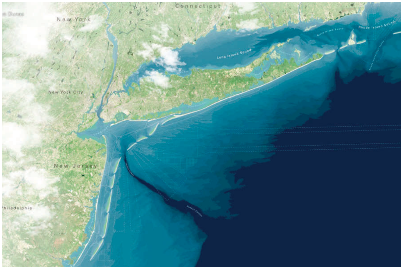
Abb. 67 Als Reaktion auf die Sturmflut, welche durch den Hurrikan „Sandy“ ausgelöst wurde, entwickelten WXY Architecture und West8 das Konzept der „Blue Dunes“, einer Reihe künstlicher Inseln, welche die Metropolregion New York vor Überflutungen schützen könnten.
