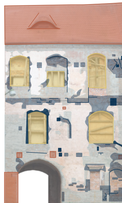
Abb. 128. Schadenskartierung Ansicht Nord Südflügel
