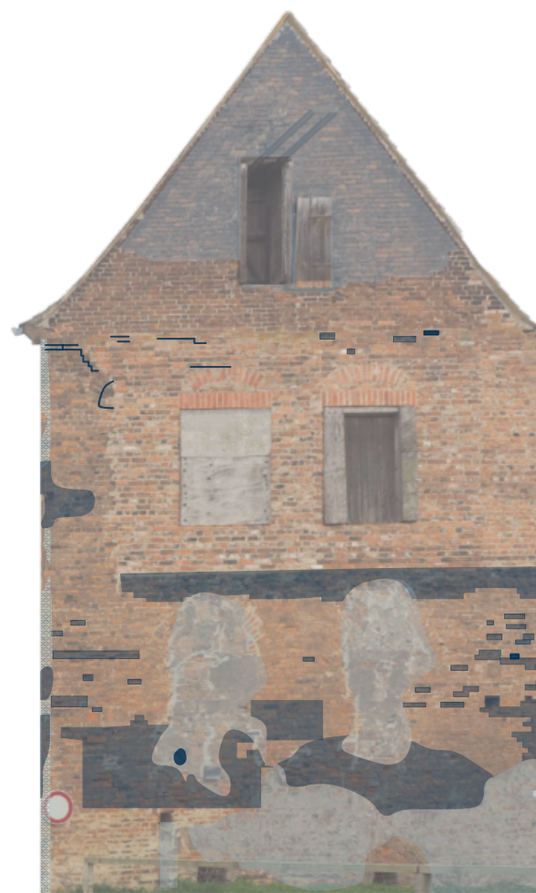
Abb. 131. Schadenskartierung Ansicht Nord Westflügel
