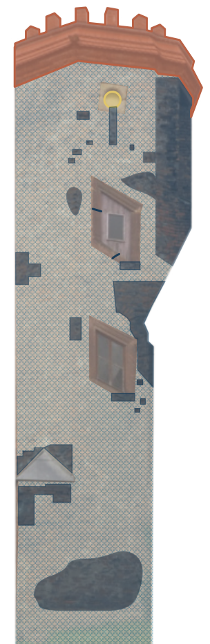
Abb. 129. Schadenskartierung Ansicht Nord Wendelstein
