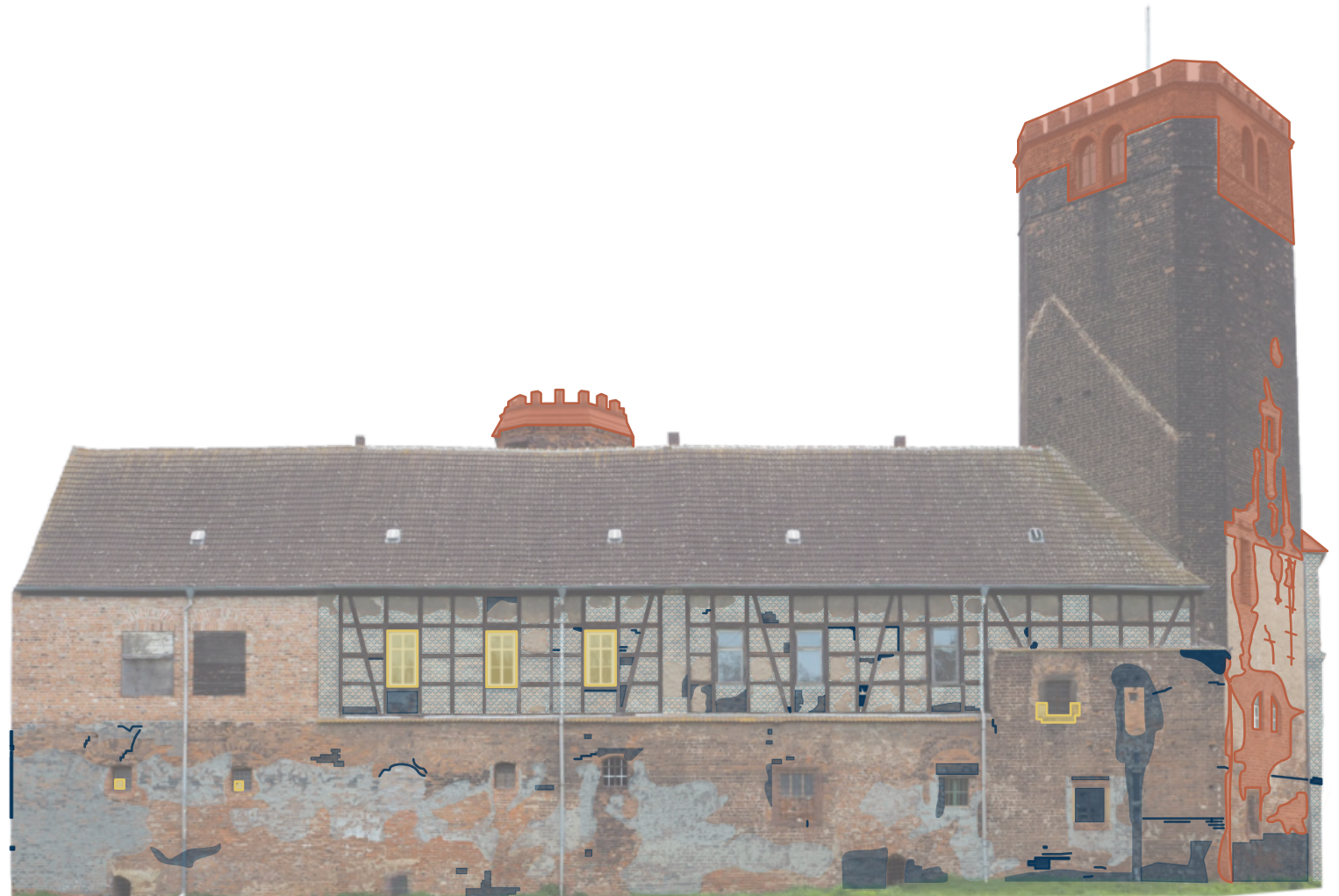
Abb. 134. Schadenskartierung Ansicht West
