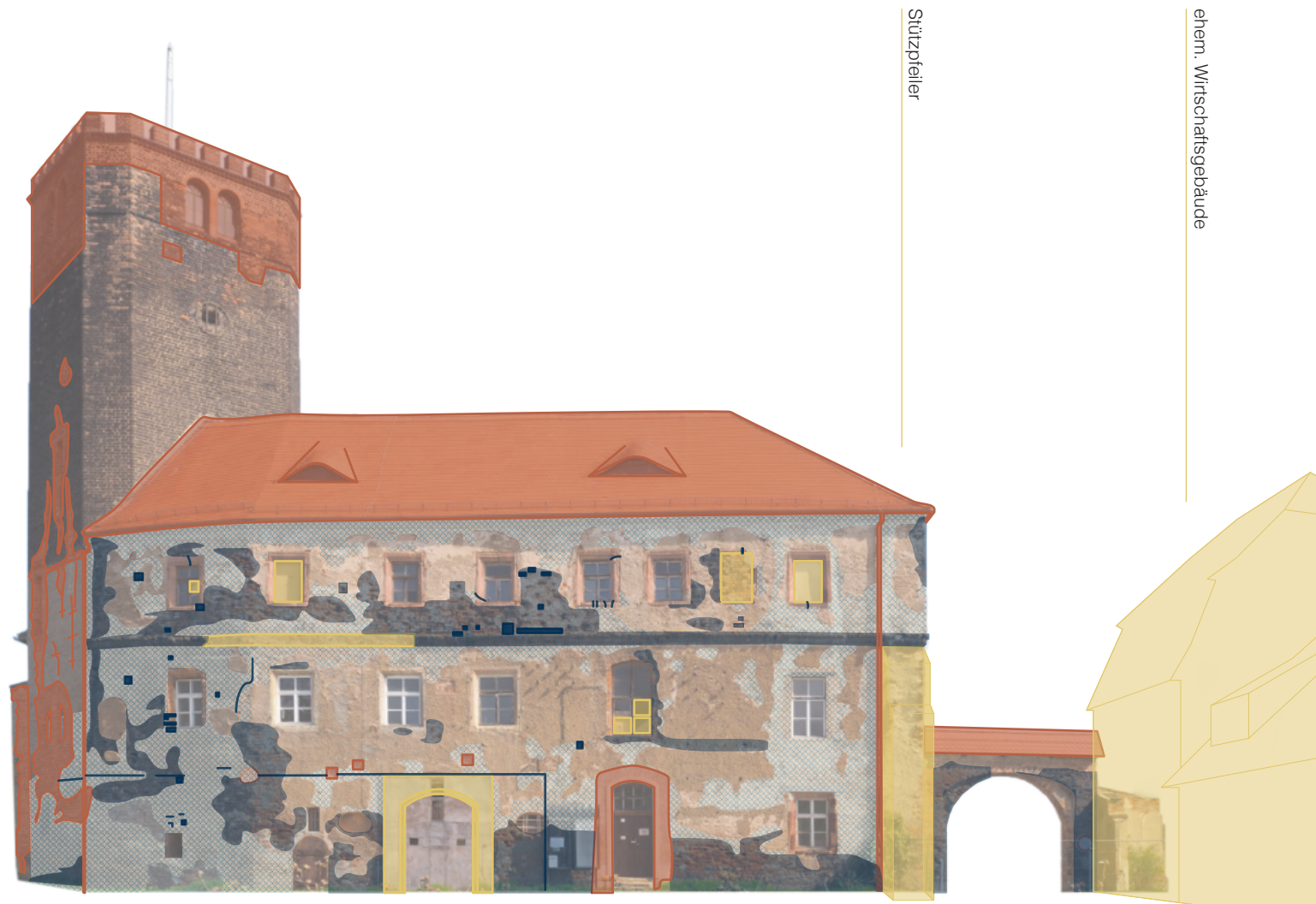
Abb. 123. Schadenskartierung Ansicht Süd
