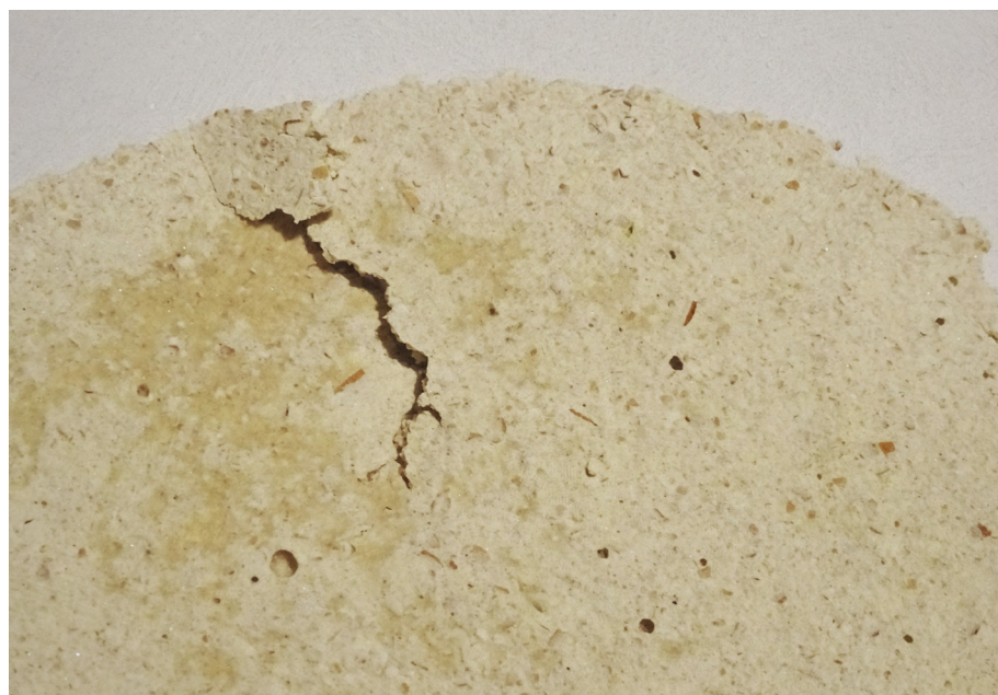
Abb. 1 / zu brüchiges Material: Mengenversuch mit 1cl Wasser
