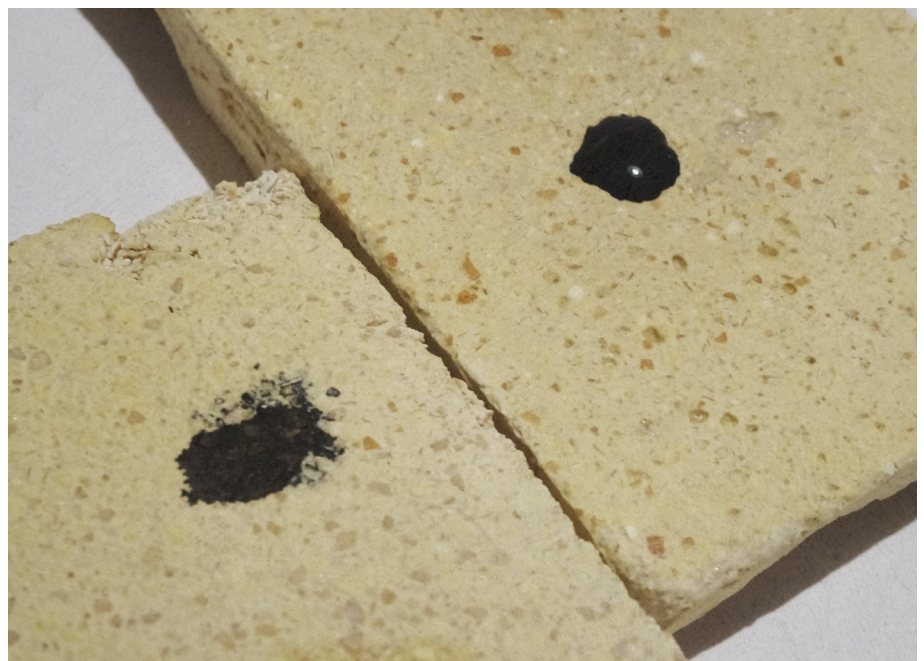
Abb. 4 / ungesierte Oberfläche vs. polierte und geseifte Oberfläche
