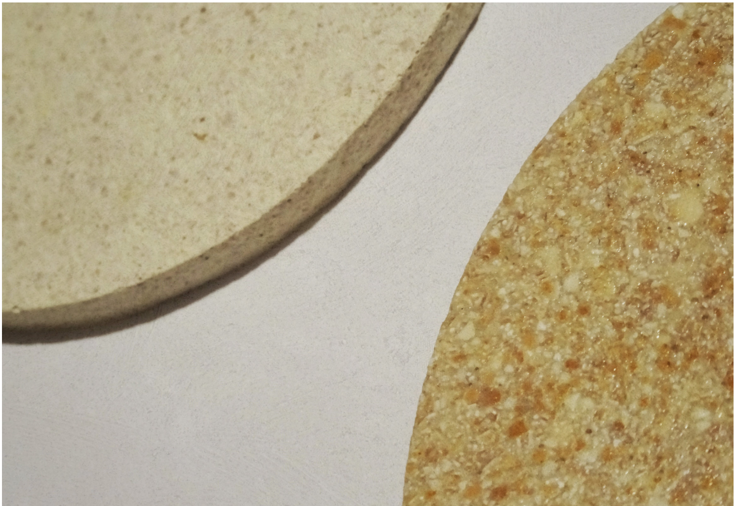
Abb. 3 / Prototyp im Ofen getrocknet vs. frisch und nass nach dem Gießen
