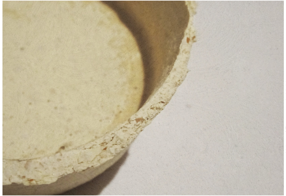
Abb. 2 / Prototyp als Hohlform gepresst
