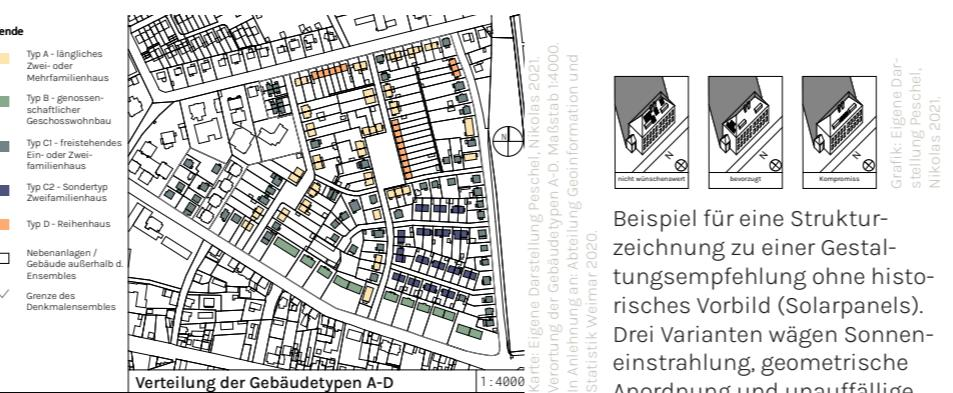
Beispiel für eine Strukturzeichnung zu einer Gestaltungsempfehlung ohne historisches Vorbild (Solarpannels). Drei Varianten wägen Sonnen einstrahlung, geometrische Anordnung und unauffällige Platzierung der Panels auf dem Hausdach ab.
