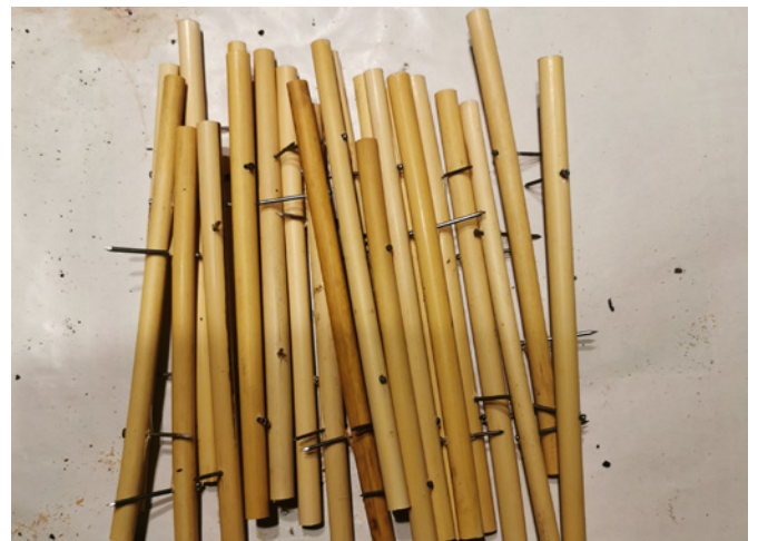
Alternative: Befestigung der Schilfrohre mit Nägeln
