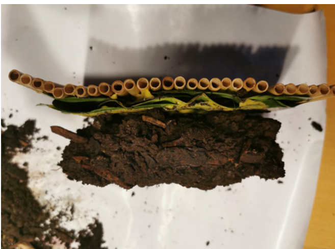
Einseitige Verkleidung der Dämmebene
