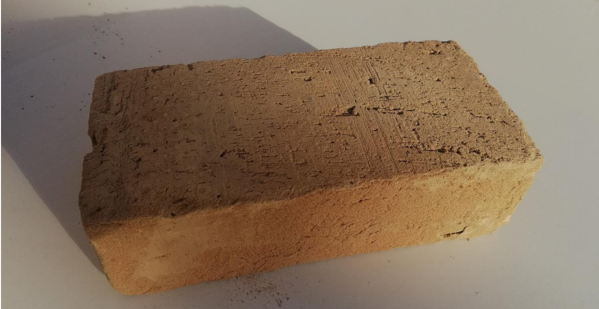
Claytec Lehmstein schwer NF 1800, Gewicht vor den Experimenten: 3520 g Zusammensetzung: Baulehm
