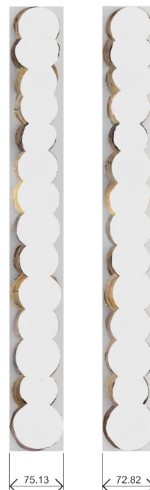
Abb. 45: Rotation von 14 Baumstämme zur Maximierung der Wandstärke: ohne Optimierung 72,82 mm (unten) und mit Optimierung 75.13 mm (oben)
