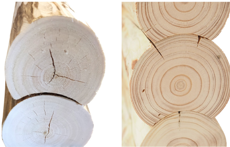
Abb. 51: Präzision der Fügung: erster Test (links) und finaler Prototyp (rechts)
