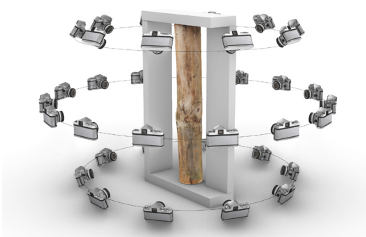
Abb. 33: Jeweils 40-50 Bilder wurden in drei Orbits um die Baumstämme herum aufgenommen.
