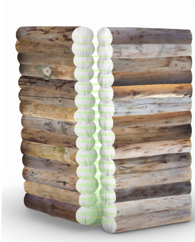
Abb. 47: Die Eckverbindung besteht aus Flächen, die in Abhängigkeit des horizontalen Durchmessers jedes Stammes generiert werden. Hierzu wurden zunächst die Schnittpunkte mit der Stammaußenkante berechnet und dann zu Linien verbunden.
