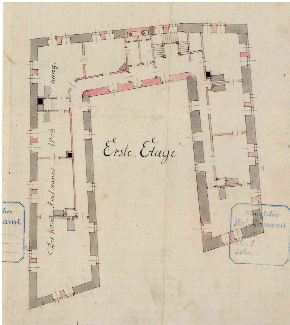
Abb. 26: Entwurfsplanung für den Umbau zur Dreiflügelanlage, vor 1768
