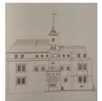
Abb. 23: Umbaumaßnahmen am Schloss im 17. Jh., Bestandsaufnahme 1753 von J.H. Schwarze (?), Rissbildung im östlichen Teil der Fassade
