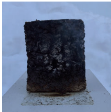
Unmittelbar nach Brandbelastung
