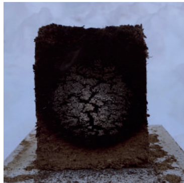
Unmittelbar nach Brandbelastung
