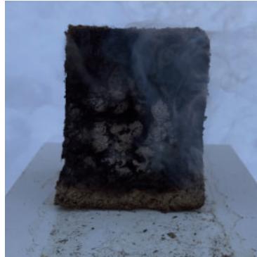
Unmittelbar nach Brandbelastung
