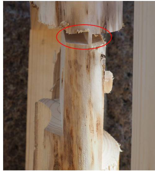
Abb. 62: Haltesteg zur Befestigung des Stammes
