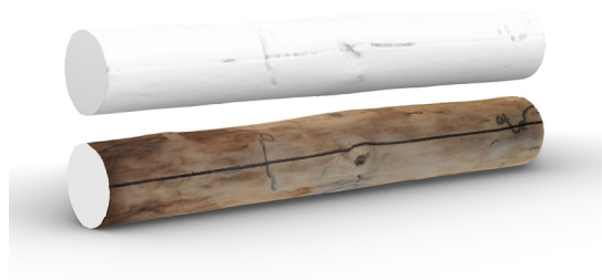
Abb. 30: Scanexperiment Nr. 3 mit Systemkamera und 3DF Zephyr (Stamm mit und ohne Textur)
