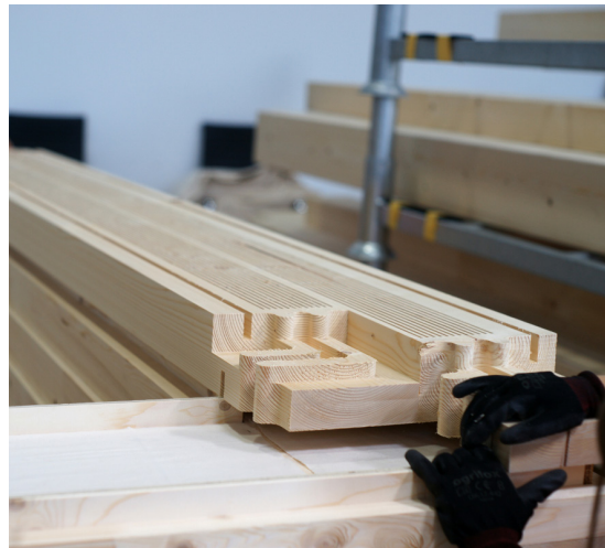
Abb. 3: Die Balken des «Timber Prototype House» haben zahlreiche Schlitz zur Erhöhung der Dämmwirkung.
