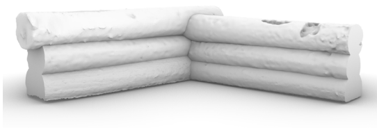
Abb. 29: Scanexperiment Nr. 2 mit Xiaomi Mii 9T und 3DF Zephyr
