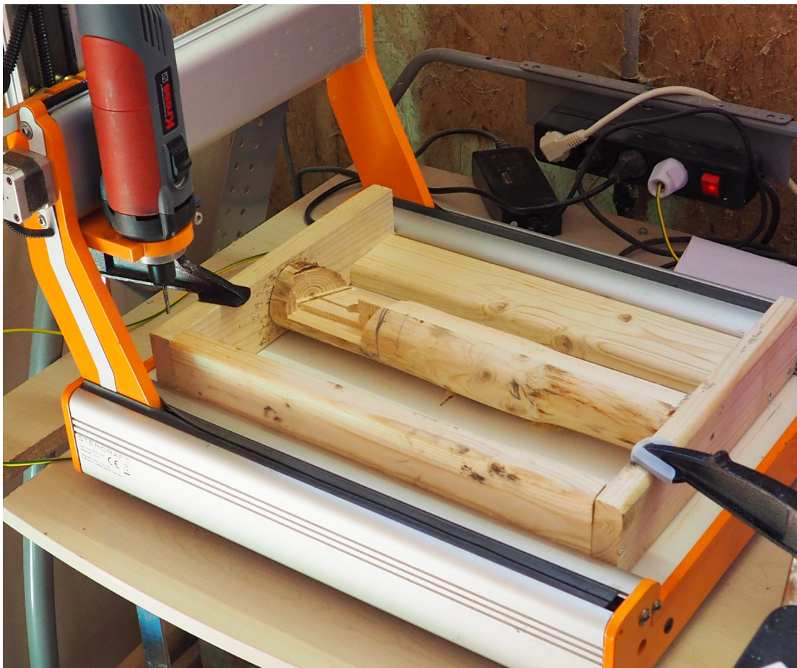
Abb. 61: Der Holzrahmen mit Baumstamm wird auf die Arbeitsfläche gelegt und mit Schraubzwingen befestigt.
