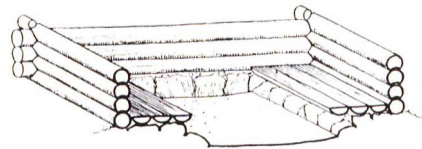
Abb. 8: Basisbildung bei einem Eldhus aus Norwegen
