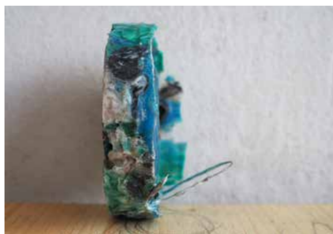
20 Einwegmasken bunt gemischt mit Heißluftföhn erhitzt
