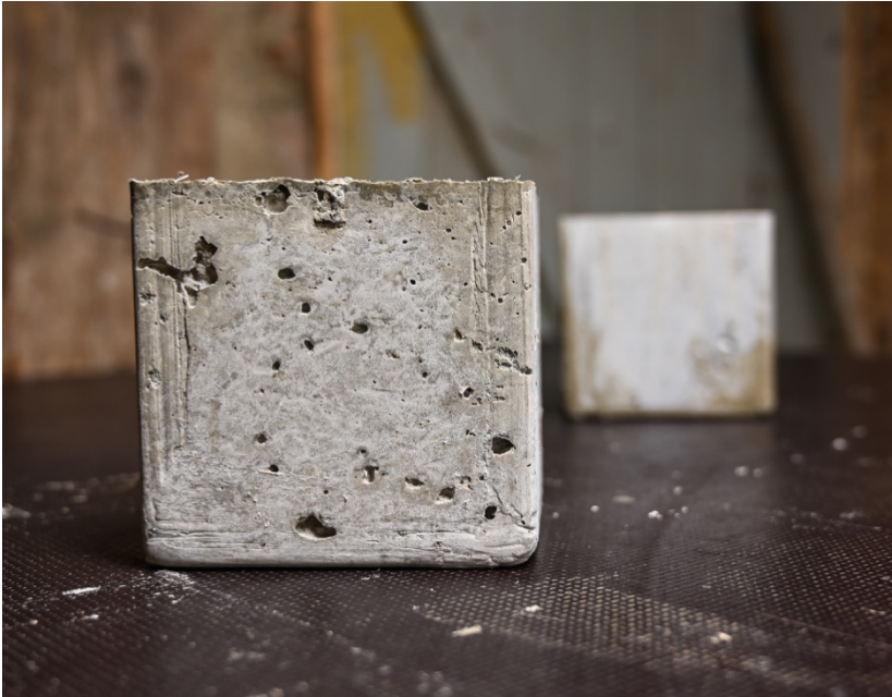
Holzbeton (oben); UHPC (unten)
