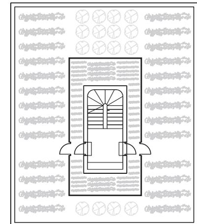
Die Erschließung von außen erfolgt über einen Steg. Dieser führt einmal um das gesamte Gebäude herum. Der Innenraum wird durch einen zentralen Kern, der die Treppe zum Dachgarten einschließt und einen umlaufenden Flur gegliedert. Rechts und links des Kernes befinden sich die Küchen mit angrenzendem Kühl- und Lagerraum. Der umlaufende Flur lädt ein, den Innenraum einmal im Kreis gehend zu erschließen. So findet sich das Motiv des Kreises im Innen- und Außenraum wieder.
