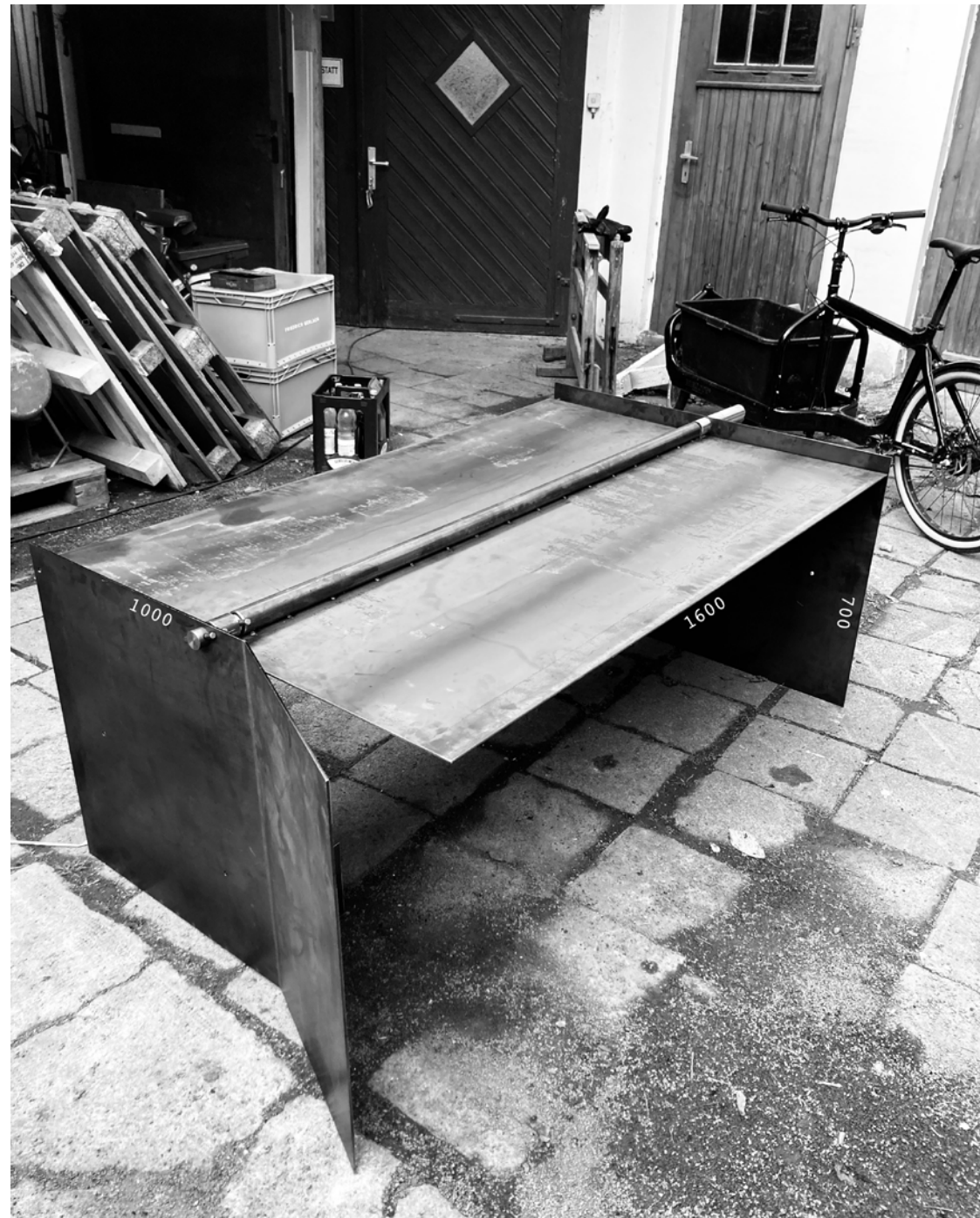
Werkstatt (Objekt Baustahl S235JR 1600x1000x700mm)
