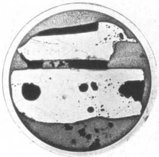
abb. 16 metallstrukturen 2 kupferstücke zusammengesweißt ( 2\frac{1}{2} mal vergrößert)
