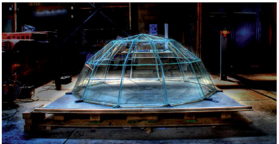
Kuppel aus geklebten Glas-Kunststoff-Elementen.
