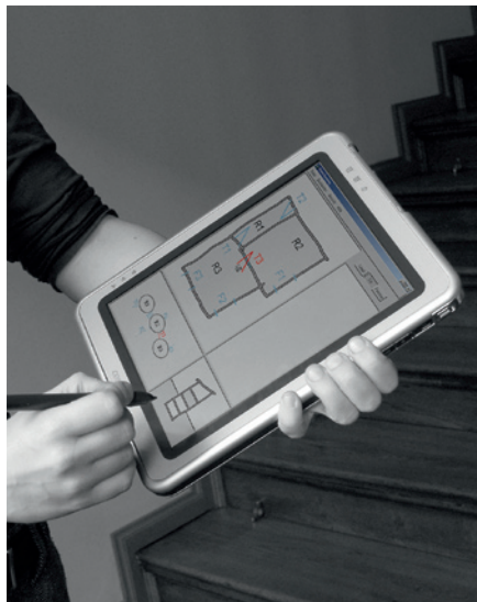
Werkzeug für die mobile Ersterfassung von Bestandsgebäuden. Fotos: Professur InfAR
