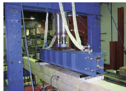
Holzbalken mit kohlefaserverstärktem Kunststoff (CFK) im Vierpunkt-Biegeversuche mit elektronisch gesteuerten Hydraulikpresse. Foto: Markus Jahreis
