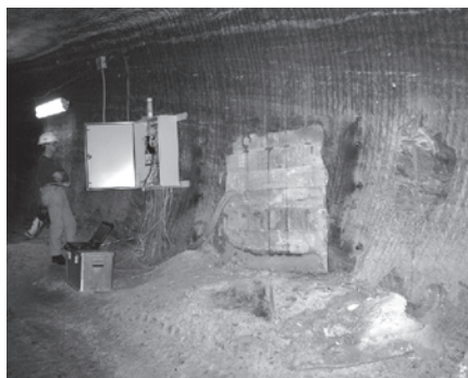
Messung der Feuchteverteilung nach dem Einbau der TDR-Sensoren in einem Verschlussbauwerk in der Grube Teutschenthal.
