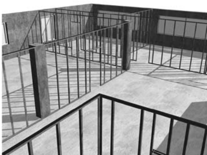
Visualisierung eines Simulationslaufs zur Herstellung von Trockenbauwänden in einem Geschoss. Bild: Professur Baubetrieb und Bauverfahren.
