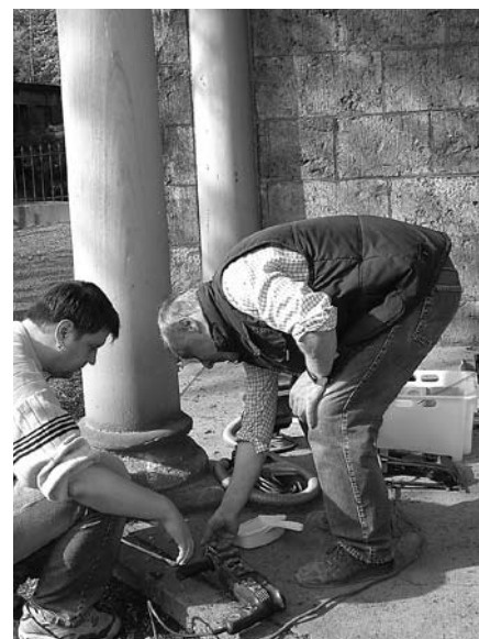
Baustoffanalyse an einer Sandsteinsäule der Friedhofskapelle in Ehringsdorf. Bild: FIB
