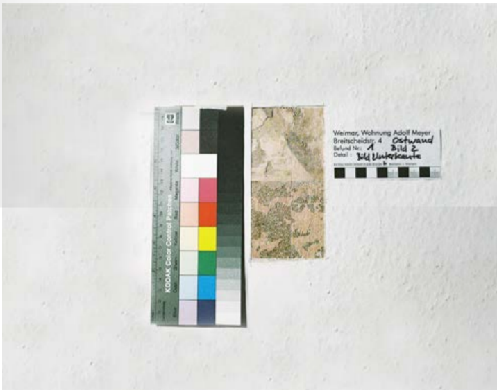
Erste Erkundung an der Ostwall 2008, Teile der Figurlinie am unteren Rand werden sichtbar
