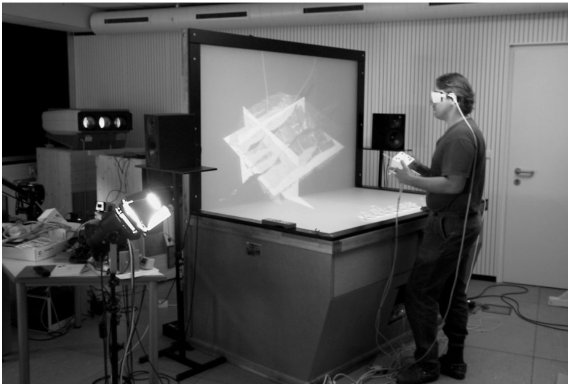
Abb. 2: Die Collaborative Responsive Workbench: Stereoskopische Bilder werden von der Rückseite auf zwei senkrecht zueinander stehende Projektionsflächen projiziert. Dies hat gegenüber einer einseitigen Workbench den Vorteil, daß man das virtuelle Modell im Raum vor sich darstellen kann. Es entsteht ein wesentlich größeres Interaktionsvolumen.
