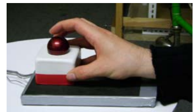
Abb. 2.18: Kugelmaus. Manipulation am Sockel.
