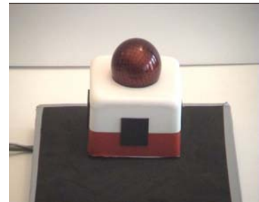
Abb. 2.16: Kugelmaus. Prinzip: SpaceMouse mit Kugelaussatz.
