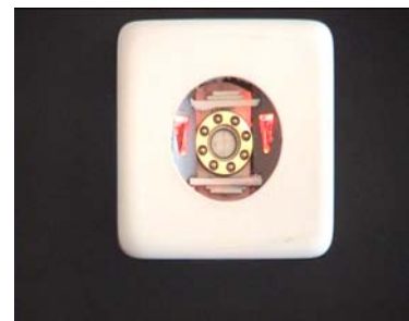
Abb. 2.17: Kugelmaus. Optische Sensoren (rechts und links) und Kugellager (Mitte).
