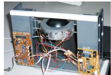
Abb. 2.10: Hier sieht man die optischen Sensoren, welche aus handelsüblichen optischen Mäusen entnommen wurden samt Platinen. Sie dienen zur Erfassung der Rotation. (Das Bild zeigt eine ältere Entwicklungsstufe des großen Kugelfisches, beim aktuellen ist es jedoch ähnlich!)
