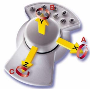
Abb. 2.4: Steuerungsprinzip der SpaceMouse (hier klassik).
