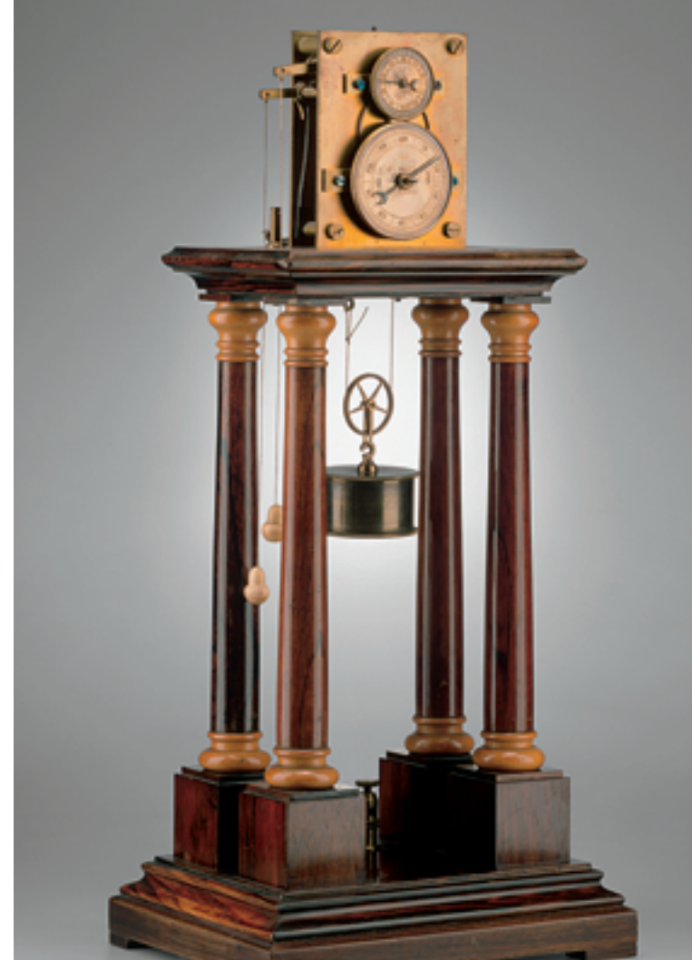
Der Uhrmacher Matthäus Hipp machte das Chronoskop zu einem Präzisionsinstrument. Das Bild zeigt eines der damals gebauten Geräte (um 1865).
