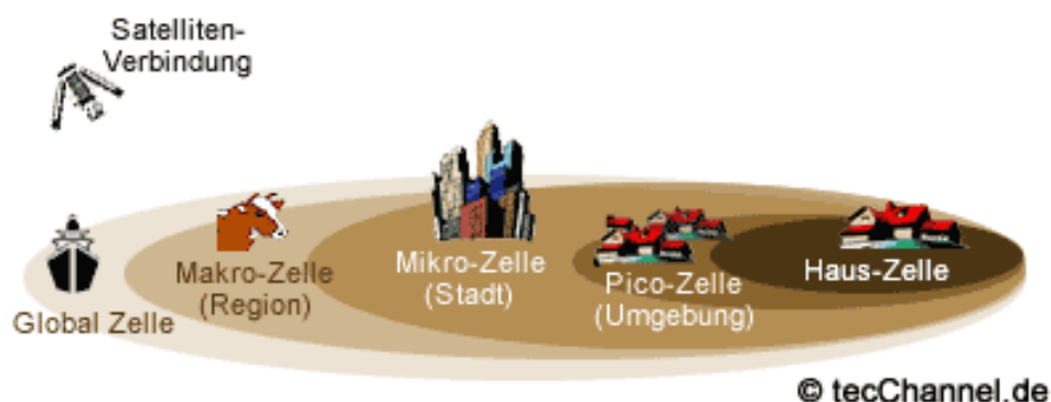
Abbildung 2 Versorgungsebenen des UMTS-Netzes
