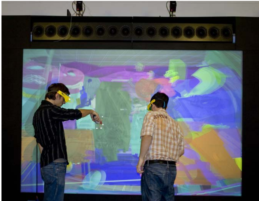
Abbildung 2.18: Zwei Nutzer untersuchen und diskutieren die räumliche Aufteilung des Motorraums eines PKWs im 3D-Lernraum. Das Foto wurde ohne Shutter vor der Kamera aufgenommen, daher sind zwei Stereo-Bildpaare gleichzeitig sichtbar.
