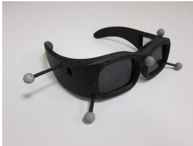
Abbildung 2.20: Kabellose Shutterbrille mit funkbasierter Ansteuerung und Synchronisation
