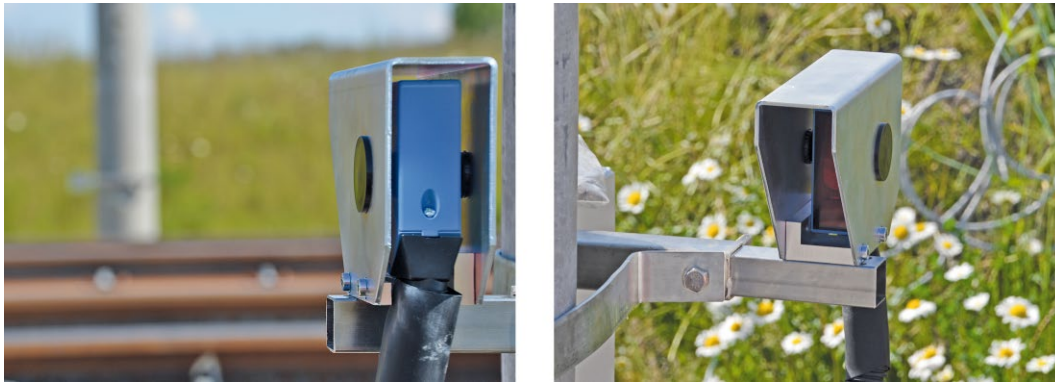
Bild 2 Lichtschranken zur Auslösung der Messungen Photoelectric sensors for triggering the event
