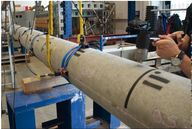
Bild 2 Experimenteller Aufbau inklusive Auflager des Betonmasts mit Seilen Experimental setup including support of the concrete pole with ropes
