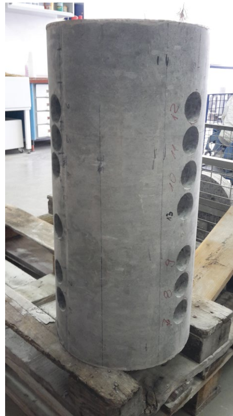
Bild 10 Betonmast mit Bohrungen Concrete pole with drill cores
