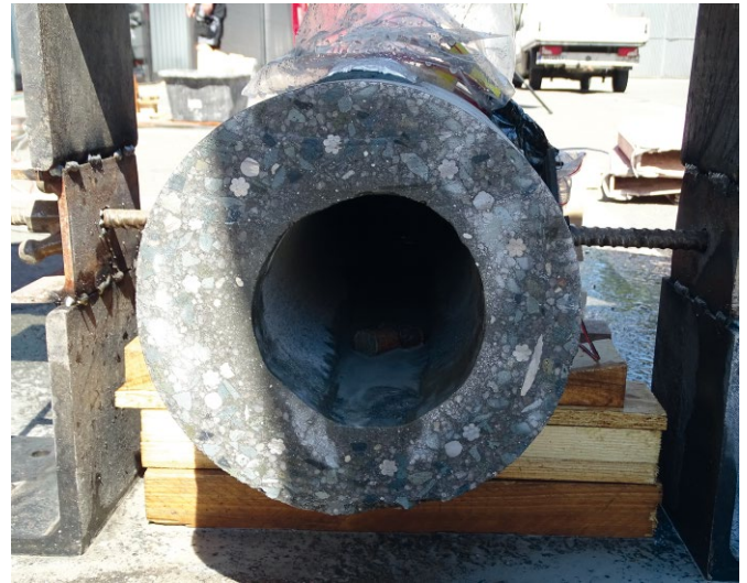
Bild 7 Unregelmäßig geformter Querschnitt eines Betonmasts Irregularly shaped cross section of the concrete pole
