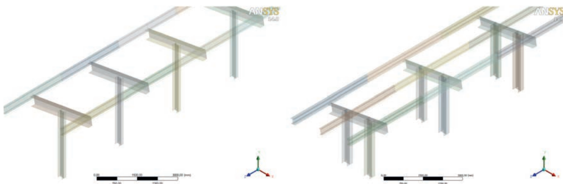
Bild 4. FEM-Modell der untersuchten Dachkonstruktionen mit zwei Dachpfetten (links, Variante A) und drei Dachpfetten (rechts, Variante B)
