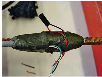
Bild 4. Gekapselte DMS auf der Bewehrung
