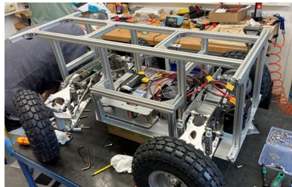
Abbildung 2: Das Modellfahrzeug NEP2N mit selbst geplanter Rahmenkonstruktion
