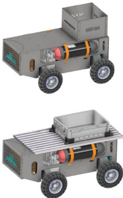
Abbildung 4: Aufbauten des Fahrzeuges, links: Betonwürfelhalterung, rechts: Nutenplatte mit Eurobox
