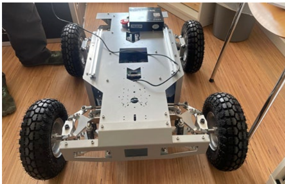
Abbildung 1: Grundlage für das Modellfahrzeug NEP2N vor dem Rückbau des Chassis
