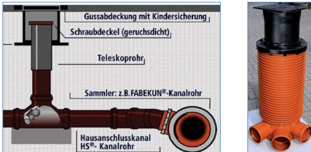
Abbildung 10: Prinzip der Anordnung einer Revisionsöffnung (links, Quelle: Fa. Fabekun), Kontrollschacht Varios 400 (rechts, Quelle: Fa. PipeLife)
