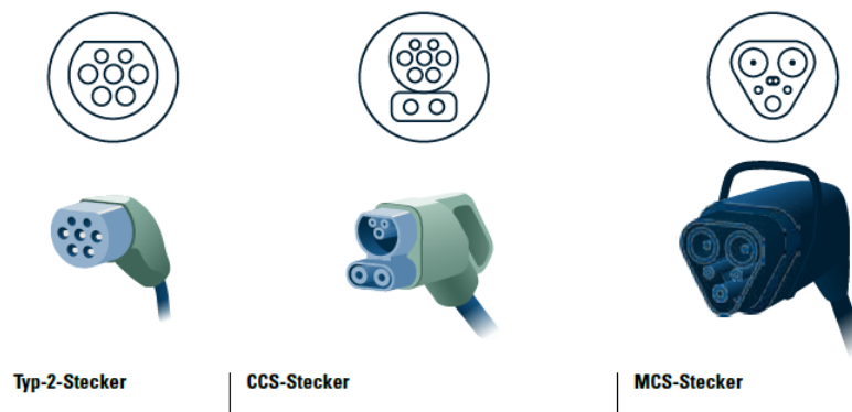
Abbildung 2 Übersicht über verschiedene Ladestecker (Typ-2-, CCS- und MCS-Stecker) 55
