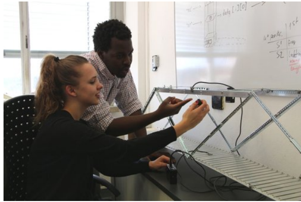
Im Sensoriklabor erproben Studentin Henrieke Fritz und Dipl.-Eng. Everett M. Mthunzi, Professur Informatik im Bauwesen, die sensorbasierte Bauwerksüberwachung. Foto: Maria Steiner
