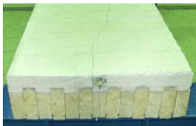
Deckenelement während Belastung, reines Hybridelement und möglicher Aufbau
