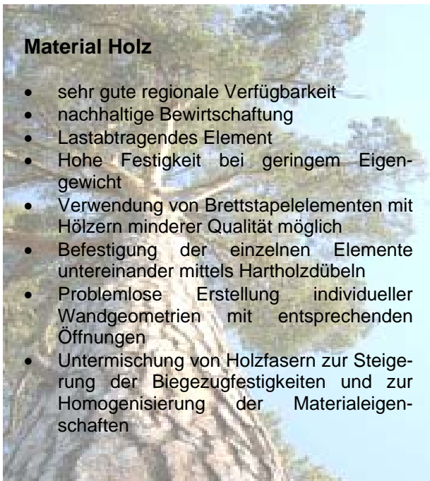
Wandelement als Brettstapelement
