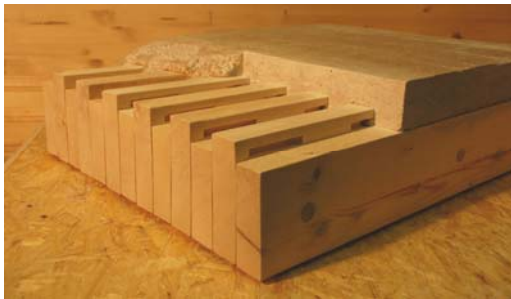
Baustoffe Holz und Calciumsulfatestrich im Verbund
