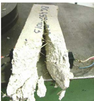
Abb. 5: Druckbelastung bei faserbewehrten Prismen
