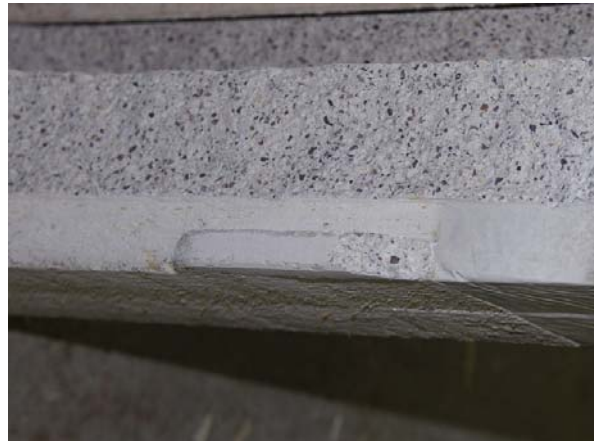
Abb. 79: Im Bereich der größten Horizontalverschiebung aufgetrenntes Plattenelement (links) und nach dem Versuch abgenommenes Anhydritfragment mit eingebetteten Holzfasern der Brettstapelelement-Oberfläche (im Bild rechts unten) und Bereich der ausgefüllten Fräsung als Anhydrit-Nocke (rechts)
