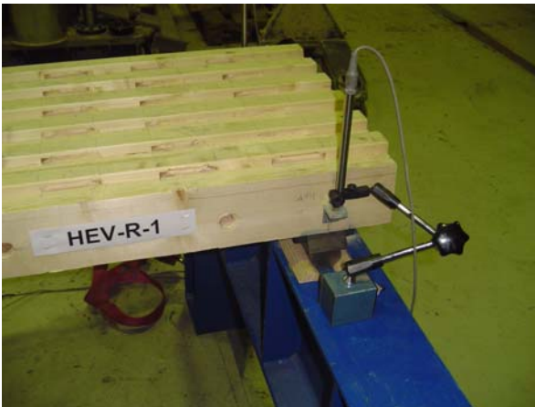
Abb. 78: Deckenelement mit alternierenden Lamellen und seitlichen Einfräsungen als Rohelement (links) und mit Anhydrit-Deckschicht (rechts)
