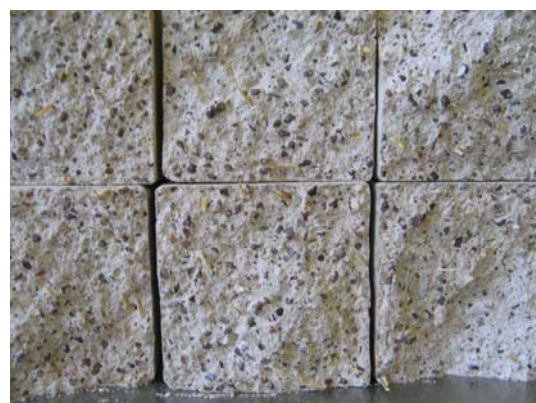
Abb. 6: Faserverteilung in der Estrichmatrix
