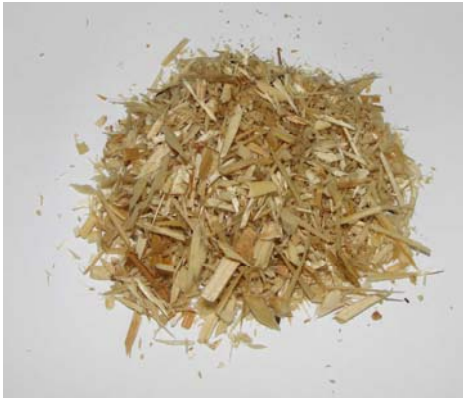
Abb. 1: Holzfasern, behandelt mit Silikonöl
