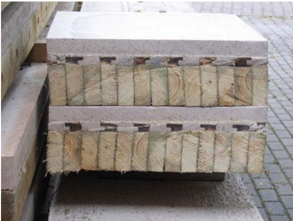
Abb. 79: Im Bereich der größten Horizontalverschiebung aufgetrenntes Plattenelement (links) und nach dem Versuch abgenommenes Anhydritfragment mit eingebetteten Holzfasern der Brettstapelelement-Oberfläche (im Bild rechts unten) und Bereich der ausgefüllten Fräsung als Anhydrit-Nocke (rechts)
