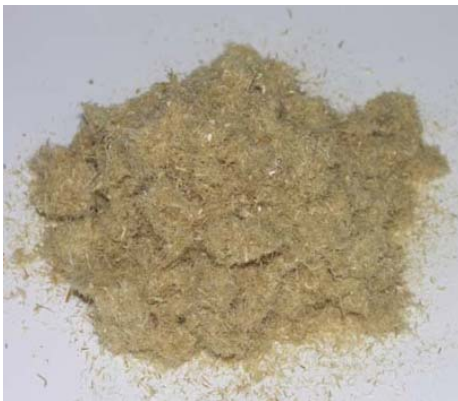
Abb. 3: Hanffasern, Länge ca. 3 mm
