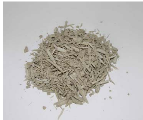
Abb. 4: Holzfasern, behandelt mit wässriger Anhydrit-Lösung
