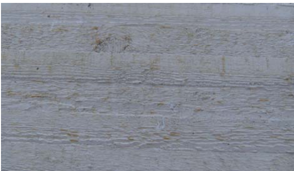
Abb. 52 Bestehender Verbund zwischen mineralischer Deckschicht und Holzoberfläche durch Holzfasern im Calciumsulfatfließestrich; Wand-Deckschicht nach Demontage nach dem Versuch (links) und Deckschichten aus Scherversuchen mit Putzschiene und Trapezprofil sowie eingebetteten Fasern (rechts) der Holzoberfläche
