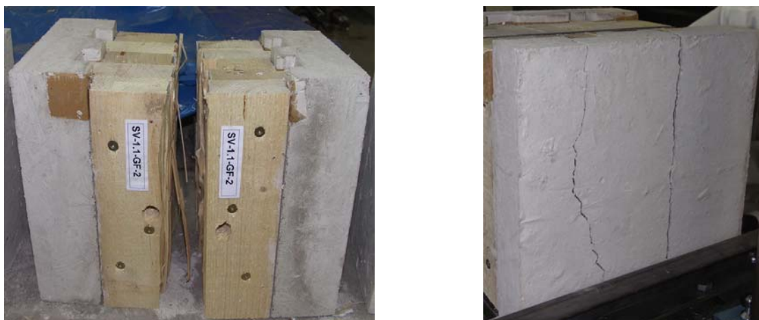
Abb. 14 Serie SV-1.1 und SV-1.3 nach Belastung, Spannungsrisse oberhalb der versetzten Lamellen
