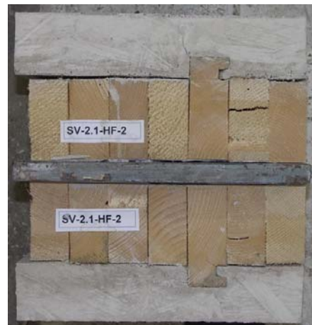
Abb. 9 Verformungen durch Feuchtigkeit eines halben Probekörpers der Versuchsserie SV-2.1-HF
