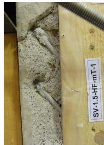
Abb. 16 Vergleich Maximalkräfte der Serien SV-1.4 und SV-1.5 (links) Fehlstellen oberhalb der Schrauben durch Zugbeanspruchung (rechts)
