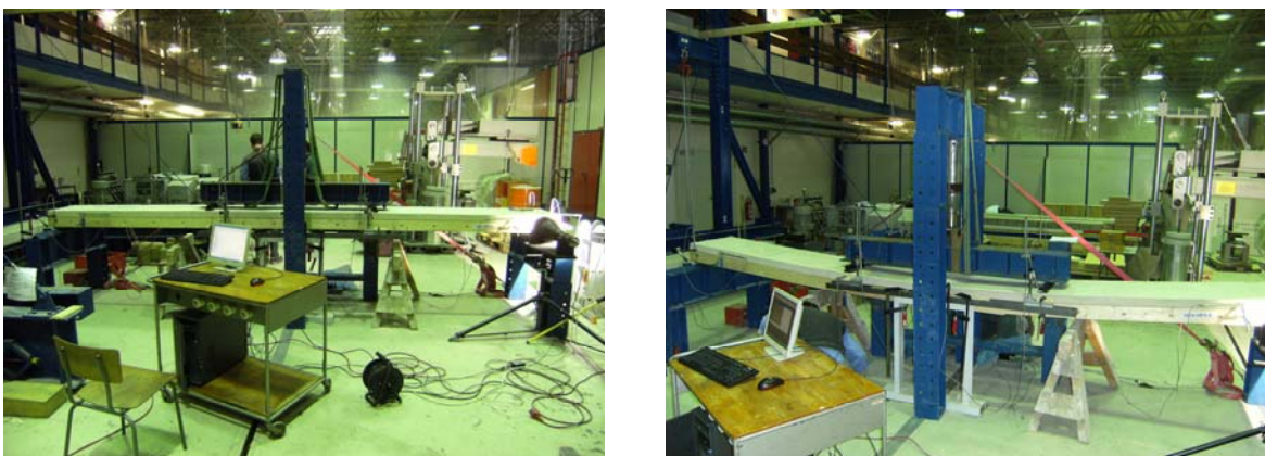
Abb. 95 Versuchsaufbau Biegeversuch vor Belastung (links) und bei Maximalbelastung (rechts)
