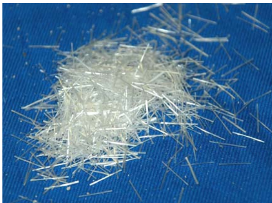
Abb. 82 Verwendete integrale Glasfaserdübel und Holzfasern
