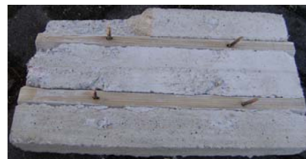
Abb. 52 Bestehender Verbund zwischen mineralischer Deckschicht und Holzoberfläche durch Holzfasern im Calciumsulfatfließestrich; Wand-Deckschicht nach Demontage nach dem Versuch (links) und Deckschichten aus Scherversuchen mit Putzschiene und Trapezprofil sowie eingebetteten Fasern (rechts) der Holzoberfläche
