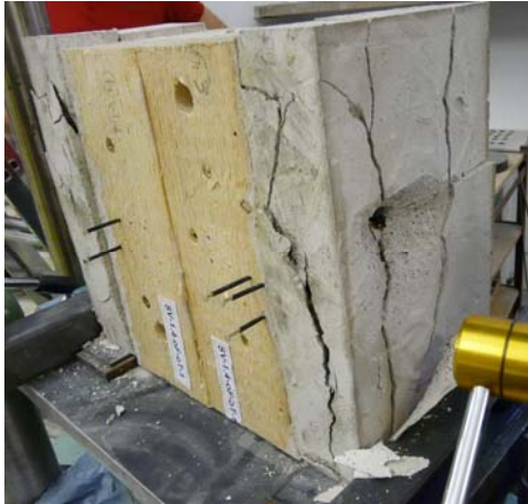
Abb. 15 Serie SV-1.4 mit typischen Estrichabplatzungen
