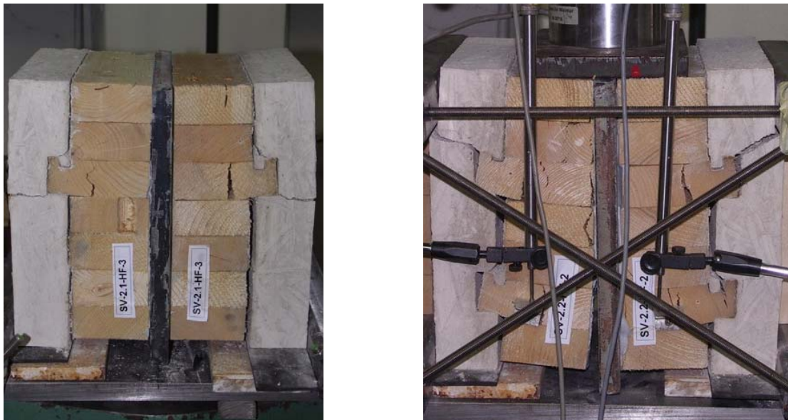
Abb. 17 Versuchsserien SV-2.1 und SV-2.2 nach der Belastung mit erheblichen Verformungen
