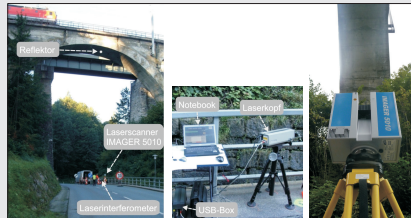
Abb. 5: Aufbau Laserinterferometrie u. TLS
