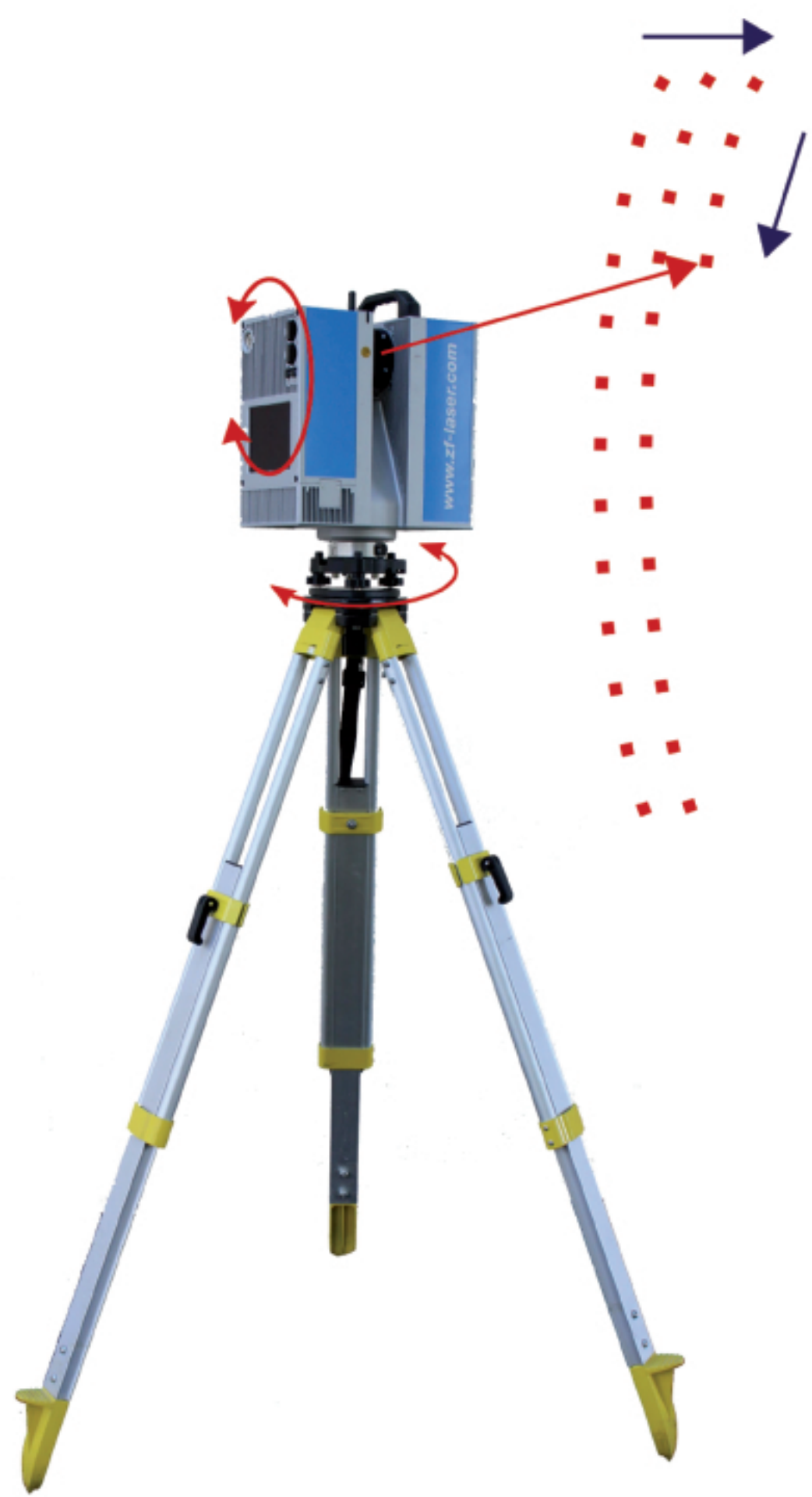
Abb. 1: Laserscanner mit visualisiertem Messprinzip
