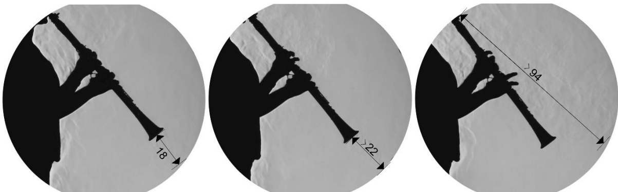
Abbildung 5 B-Klarinette vor dem Schlierenspiegel: maximale Reichweite der aus dem Schallbecher strömenden Luft beim Spielen der Note cis \approx 139 Hz (links), Note e''' \approx 1319 Hz (mittig) und der über das Mundstück entweichenden Nebenluft (rechts) [cm]
