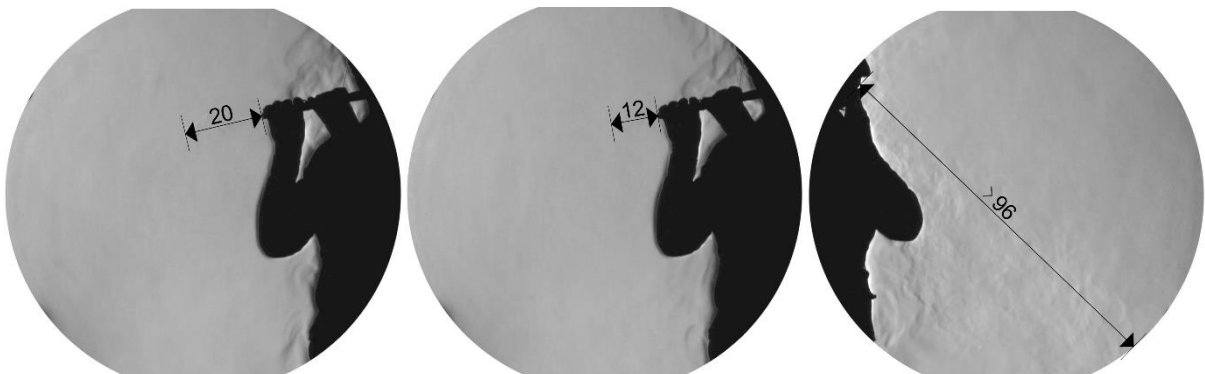
Abbildung 8 Piccoloflöte vor dem Schlierenspiegel: maximale Reichweite der aus dem Rohr strömenden Luft beim Spielen der Note e'' \approx 659 Hz (links), Note gis'''' \approx 3322 Hz (mittig) und der über das Mundstück geblasenen Luft (rechts) [cm]
