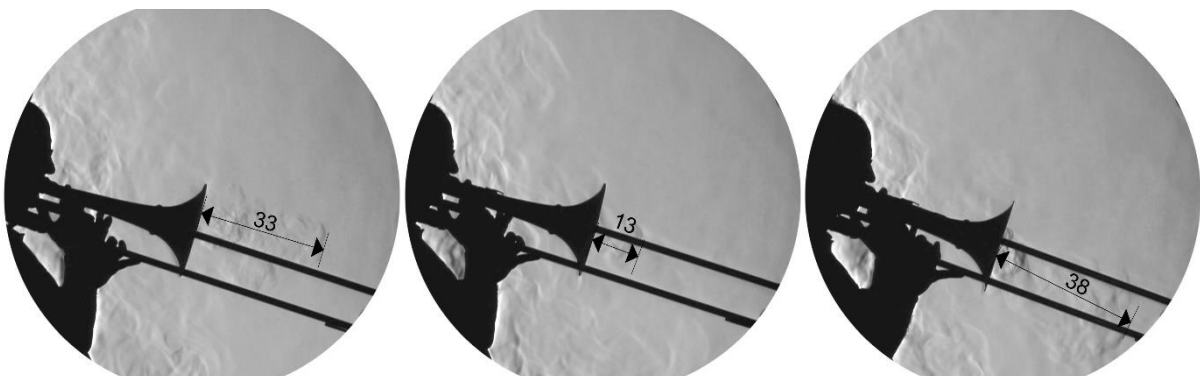
Abbildung 12 Tenorposaune vor dem Schlierenspiegel beim Spielen der Note B' \approx 58 Hz (links), Note b \approx 233 Hz (mittig) und die maximale Reichweite der aus dem Schallbecher strömenden Luft (rechts) [cm]
