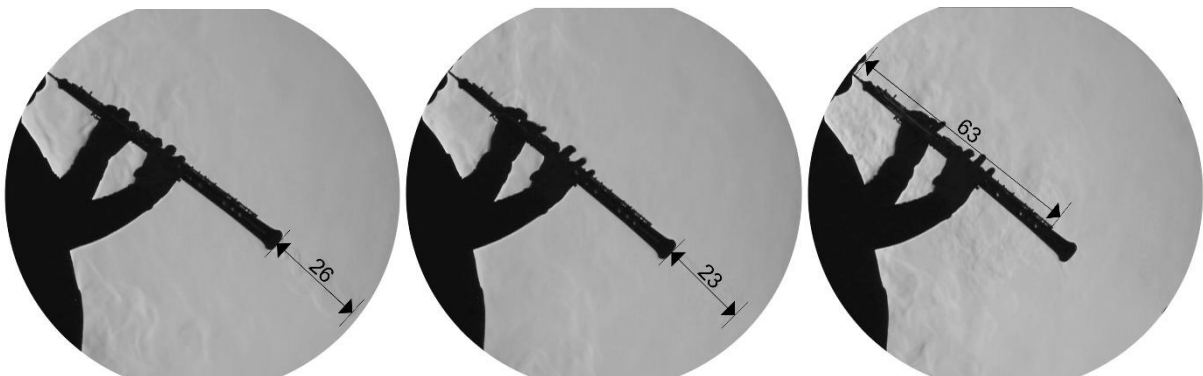
Abbildung 3 Oboe vor dem Schlierenspiegel: maximale Reichweite der aus dem Schallbecher strömenden Luft beim Spielen der Note b \approx 233 Hz (links), Note d''' \approx 1175 Hz (mittig) und beim stoßartigen Ausatmen (Abatmen bei der Oboistenatmung, vgl. Richter et al. (2020)) (rechts) [cm]
