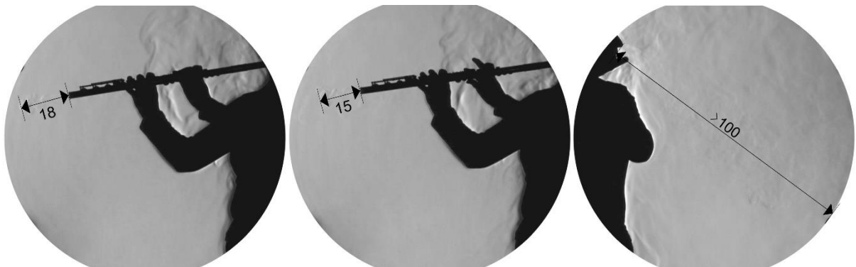
Abbildung 7 Querflöte vor dem Schlierenspiegel: maximale Reichweite der aus dem Rohr strömenden Luft beim Spielen der Note e' \approx 330 Hz (links), Note f''' \approx 1397 Hz (mittig) und der über das Mundstück geblasenen Luft (rechts) [cm]
