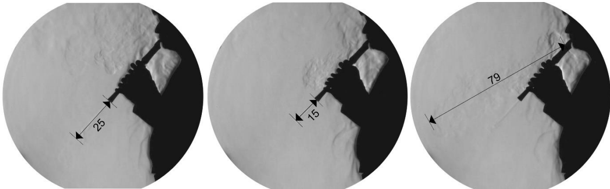
Abbildung 9 Sopranblockflöte vor dem Schlierenspiegel: maximale Reichweite der aus dem Schallbecher strömenden Luft beim Spielen der Note c'' \approx 523 Hz (links), Note g''' \approx 1568 Hz (mittig) und der aus dem Fenster austretenden Luft (rechts) [cm]
