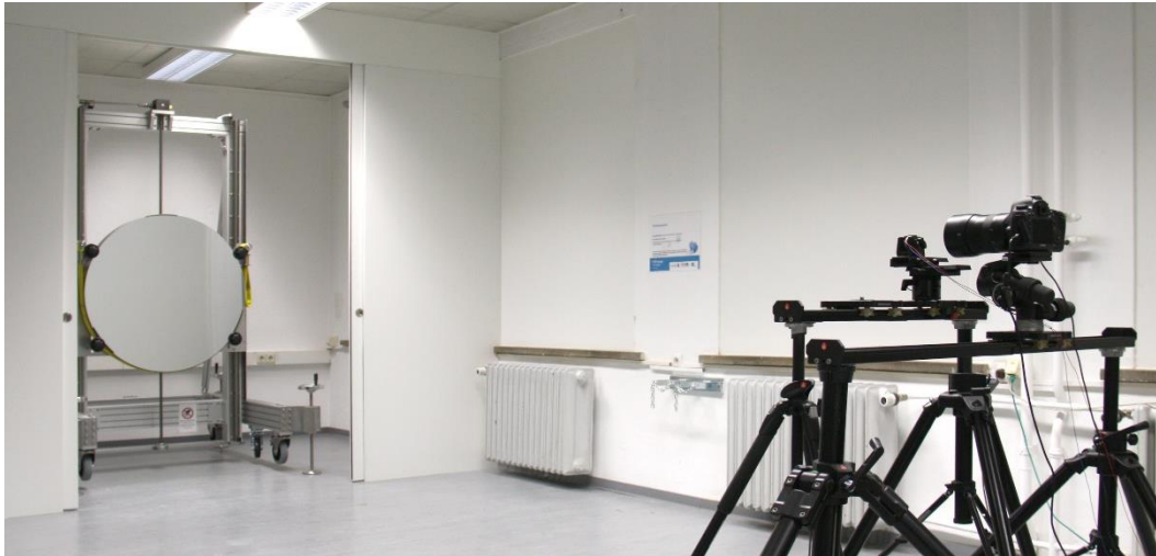
Abbildung 1 Versuchsaufbau des Schlierensystems an der Professur Bauphysik der Bauhaus-Universität Weimar
