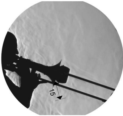
Abbildung 13 Die maximale Reichweite der aus dem Schallbecher strömenden Luft mit Dämpfer [cm]
