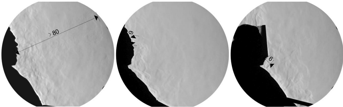
Abbildung 8 Bariton vor dem Schlierenspiegel: maximale Reichweite der aus dem Mund strömenden Luft ohne Mund-Nase-Bedeckung (links), mit herkömmlicher OP-Maske (mittig) und mit Visier (BauhausUniVisor) (rechts) [cm]
