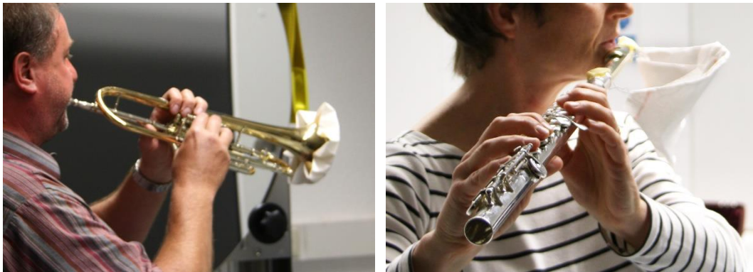
Abbildung 3 Trompete mit vorgespanntem Filter (links) und segelförmiger Filter am Kopfstück der Querflöte (rechts)
