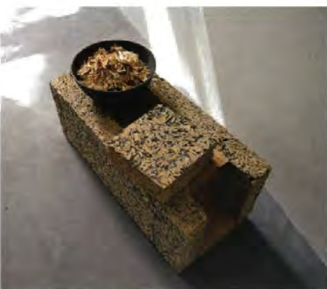
Holzbeton besteht aus Holzhäckseln und Zement als Bindemittel
