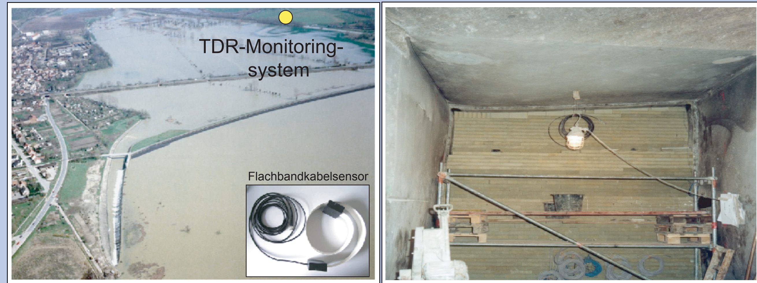
Bild 1: (links) Luftbild eines Hochwasserereignisses an der Unstrut bei Straußfurt/Thüringen am 15.04.1994. Am markierten Deichabschnitt wurde ein TDR-Monitoringsystem 2007 installiert [7]. (rechts) Streckenverschlussbauwerk in einem Salzbergwerk in Sondershausen [6].
