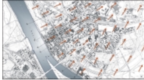
Bild 9 GW- Strömung orthogonal zum Rhein (bei Rheinhochwasser - Pfeile)
