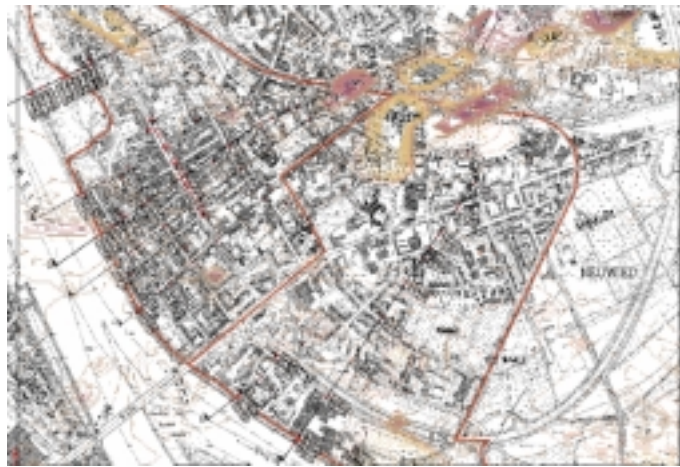
Bild 12 Darstellung der Höhenlage der Deckschicht über dem Stadtgebiet Neuwied (Höhenlinien)
