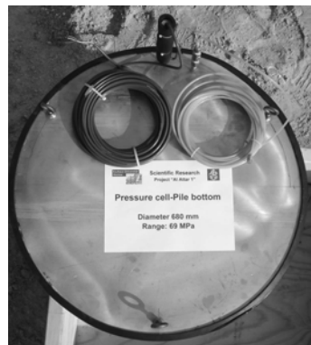
(b) Pfahlfuß-Druckzelle, 4855 (b) Pile-Tip Pressure Cell, 4855
