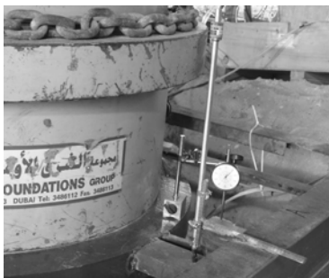
(a) vertikaler Wegaufnehmer & Messuhr (a) vertical displacement transducer & dial gauge
