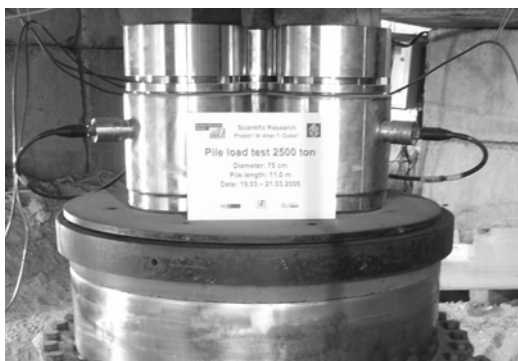
(a) Anordnung der Lastzellen auf der hydraulischen Presse (a) load cell arrangement on the hydraulic jack
