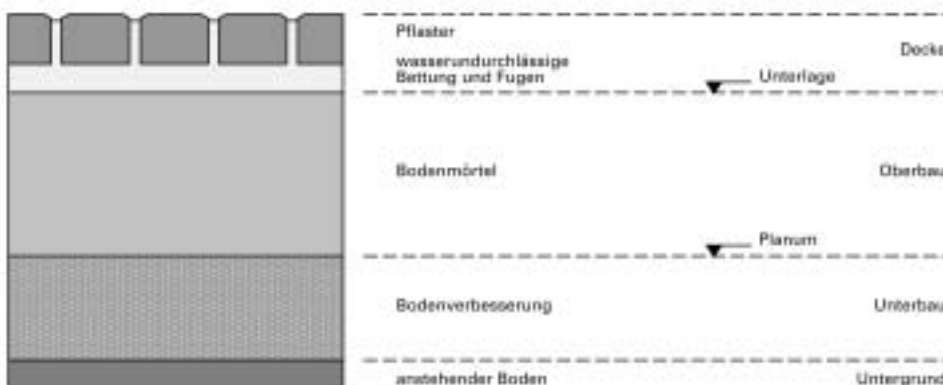
Abb. 1.22: Pflaster mit wasserundurchlässigen Fugen auf Bodenmörtel
