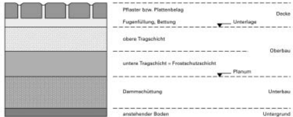
Abb. 1.17: Aufbau Pflasterdecke nach RStO
