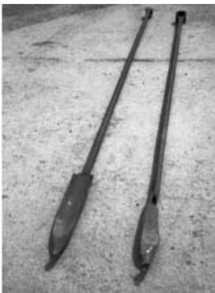
Abb. 3.7: Bohrwerkzeuge für das Röhrenbohren [Roscher, 1999]
