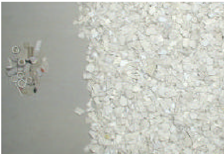
Bild 6: Ergebnis einer Probesortierung von Sanitärkeramikscherven: Produkt mit nachträglich händisch aussortierten Fremdbestandteilen (links)
