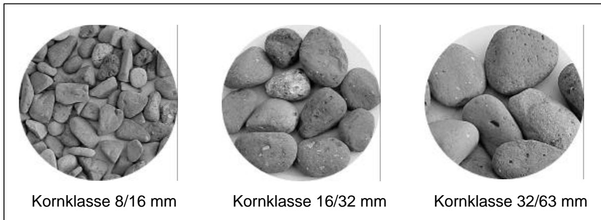
Bild 9: Kornformen der Kornklassen 8/16, 16/32 und 32/63 mm
