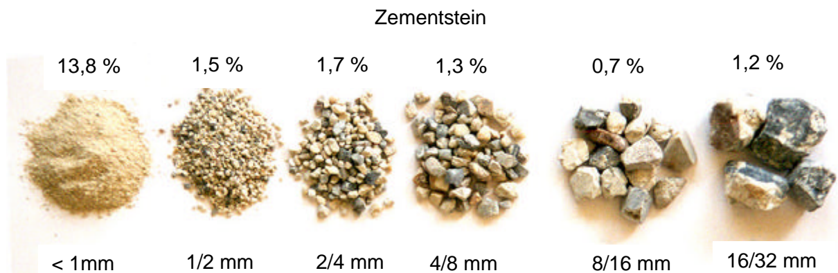
Bild 10: Beispiel der entstandenen Kornfraktionen nach der Schallimpulszerkleinerung (B25, AB16)
